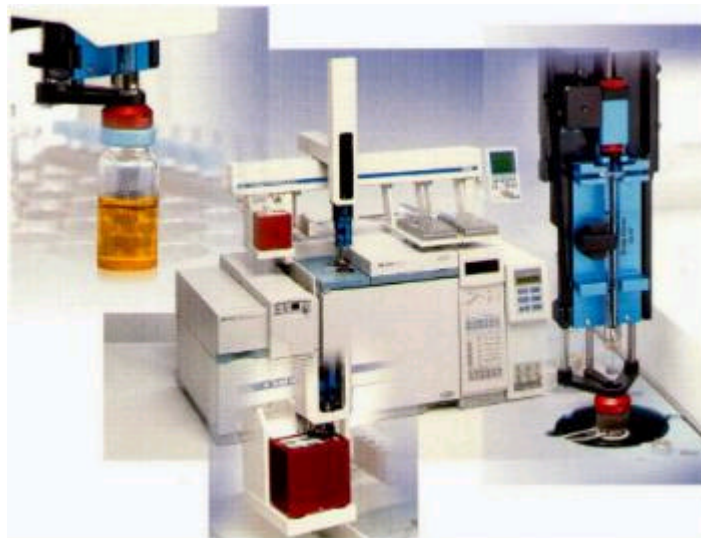
Figur 9: Bilden visar en robot monterad ovanpå en GC. Detaljbild av hantering av lösningsmedelsextraktion.
