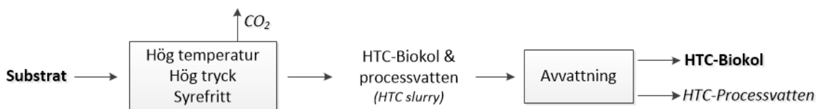
Figur 3. HTC - Hydrotermisk karbonisering.
