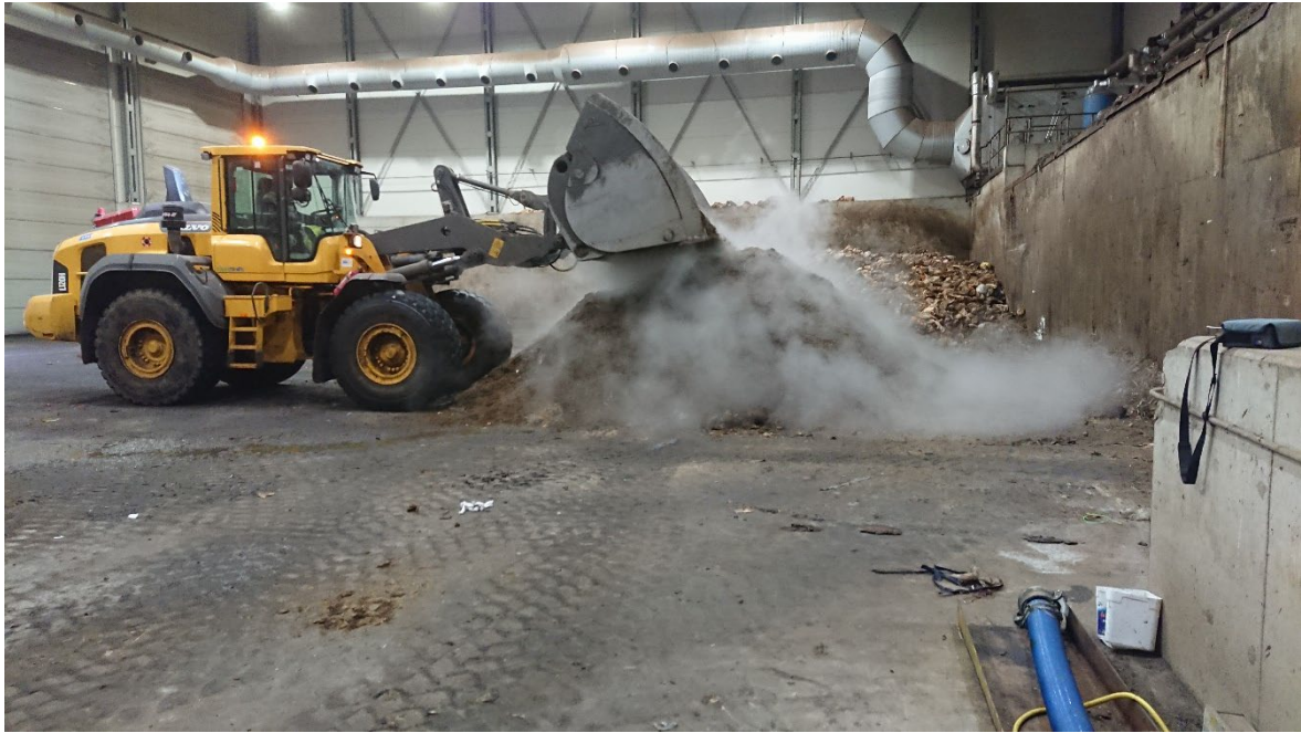
Figur 3. Mottagningshall anläggning B. Blandning av substratmixen pågår innan inlastning med lastare till inmatningsficka.
