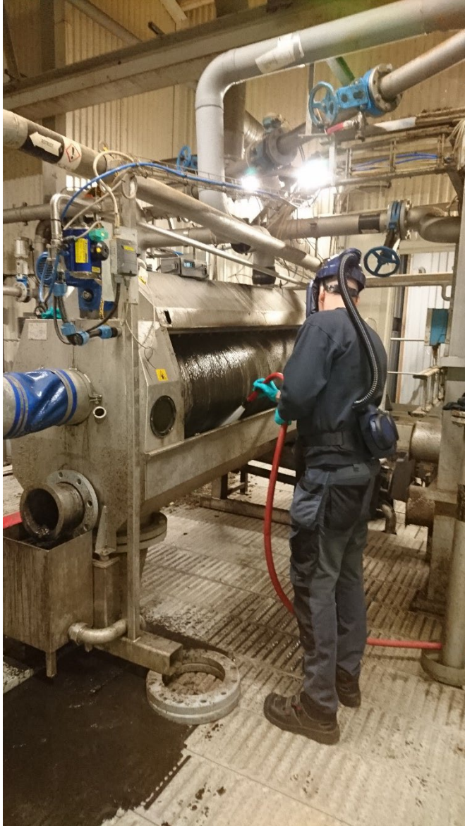
Figur 15. Underhåll/rondering i efterbehandling av biogödsel (Roto-sieve) vid anläggning A. Andningsskyddet som används är ett fläktmatat visir.
