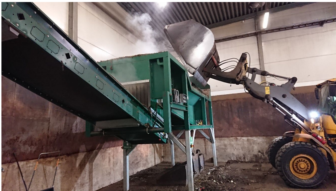
Figur 20. Efterbehandling av fast biogödsel vid anläggning B. Gällande rutin var att fläktmatat andningsskydd skulle användas vid allt arbete i hallen, även om man satt i stängd hytt med kupéfilter.
