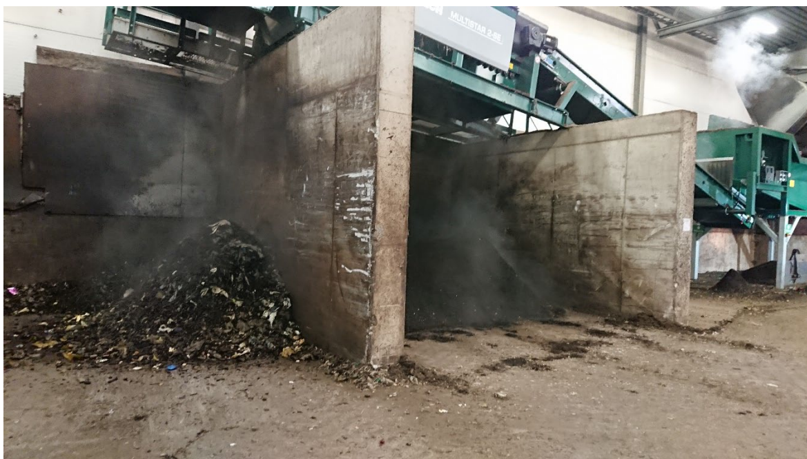
Figur 21. Efterbehandling av fast biogödsel vid anläggning B. Gällande rutin var att fläktmatat andningsskydd skulle användas vid allt arbete i hallen, även om man satt i stängd hytt med kupéfilter.
