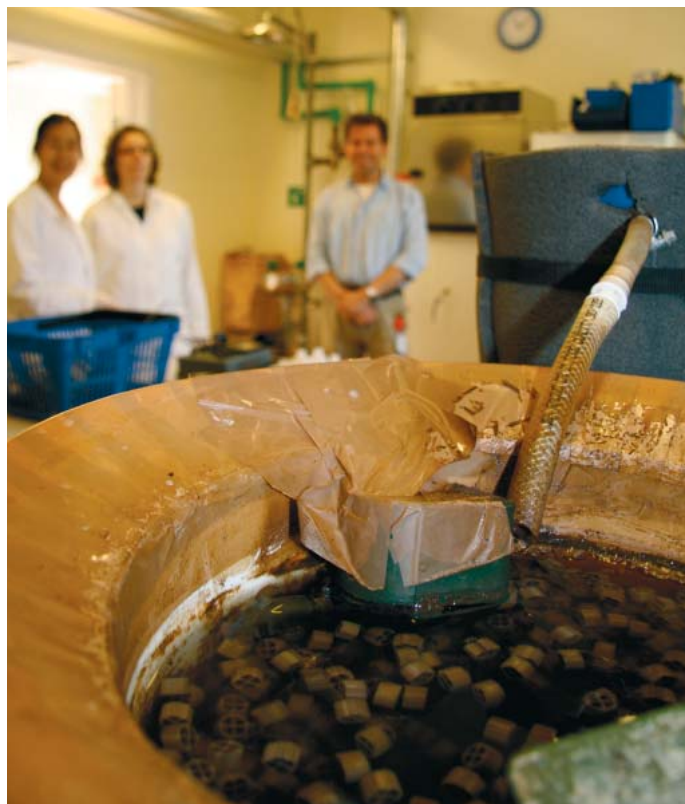
Anammoxrening med kaldnesrings i labbet. I bakgrunden ex-jobbarna Jingjing Yang och Ellen Greggio samt Lars Bengtsson.
