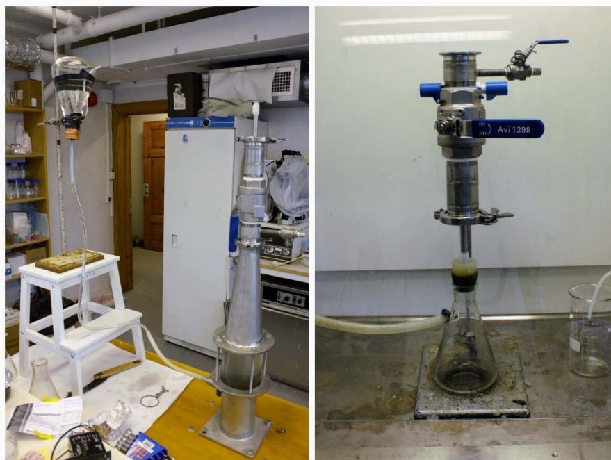
Figur 6. Till vänster visas uppställningen vid introduktion av ny saltlösning genom ventilen i provbehållaren. Till höger visas filtreringen av det separerade provet genom filter med maskstorlek 300 \mu\text{m} . Provet som går igenom filtret samlas upp i e-kolven underst i bilden och filtreras på nytt genom ett filter med maskstorlek 100 \mu\text{m} .
